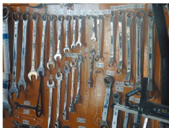
スパナを形や大きさを絵で示し、「見える化」することで置く位置を固定
